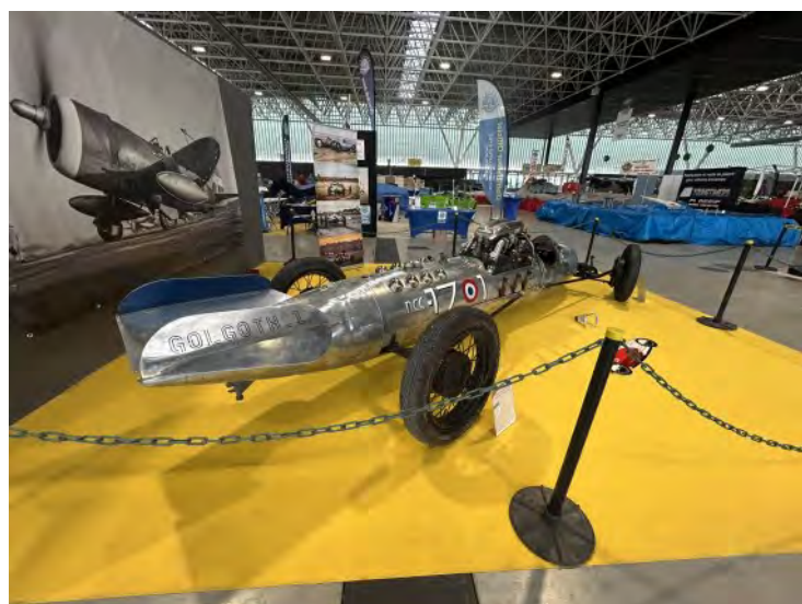
Ci-contre deux engins remarquables : un "belly tank", le Golgotha I a été fabriqué à Lunel et est assemblé dans un réservoir additionnel de Mirage IV et était associé pour l'occasion à un bon gros V8 Ford de plus de 200ch. Préparé à l'origine pour la Normandy Beach Race, il a participé depuis à bien d'autres événements., et une Leyat Helika 2V 1919.
